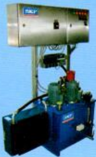
Hệ thống bôi trơn tuần hoàn
